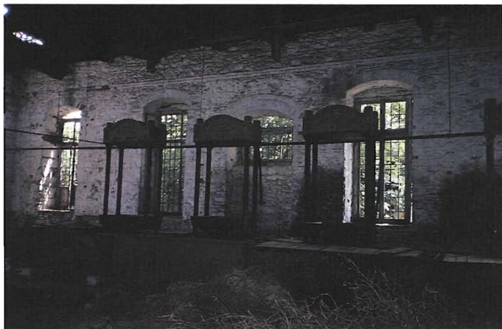
Τρία μπασσιά (πιεστήρια) του ελαιοτριβείου Ταπανλή. Συμπιέζαν με υδραυλική πίεση τα σακιά της ελαιόμαζας.
