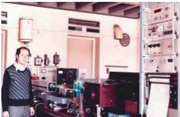
Τα δύο πρώτα φωτόμετρα Raman του Κέντρου Φυσικοχημείας. Επάνω, το φωτόμετρο Jarrell-Ash που αγοράστηκε το 1970. Δεξιά, διακρίνεται η κεφαλή του πρώτου laser στην Ελλάδα. Κάτω, ο Γιώργος Κ. Παπαβασιλείου μπροστά στο φωτόμετρο της Jobin Yvon με το laser Αργού, που αποκτήθηκαν το 1977.
