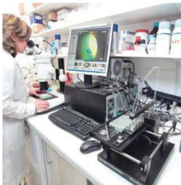
Αυτόματο σύστημα κρυστάλλωσης πρωτεϊνών OryxNano (Douglas Instruments Ltd), εφοδιασμένο με στερεοσκόπιο Leica MZ16 και ψηφιακή κάμερα CDFC320.
