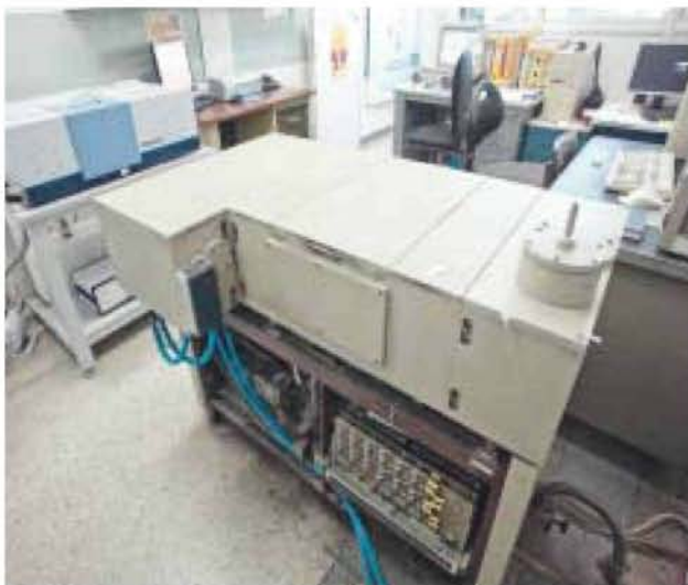
Δύο φωτόμετρα κενού που καλύπτουν την περιοχή του μέσου και άνω υπερόθρου στο ΙΘΦΧ. Σε πρώτο πλάνο, το φωτόμετρο 113ν της Bruker, που αγοράστηκε το 1985 και, σε συνδυασμό με τα φωτόμετρα Raman, χρησιμοποιείται στη μελέτη υλικών. Σε δεύτερο πλάνο αριστερά, το νέο φωτόμετρο (Bruker, Vertex 80ν), που αποκτήθηκε το 2007.
