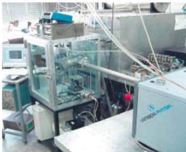
Διάταξη μικρομηχανικής επεξεργασίας υλικών με δέσμη laser στο Εργαστήριο Φωτονικής και Νανοεφαρμογών του ΙΘΦΧ. Σε πρώτο πλάνο, διακρίνεται το εμπορικό laser μοριακού φθορίου που εκπέμπει στα 157 nm. Σε δεύτερο πλάνο, φαίνεται ιδιοκατασκευασμένο laser που αποδίδει περισσότερες γραμμές στο υπεριώδες, ανάλογα με το αέριο που διεγείρεται. Στη θέση της μικρομηχανικής διάταξης μπορεί να τοποθετηθεί σύστημα για την παλμική εναπόθεση υλικών με τις ίδιες δέσμες laser.
