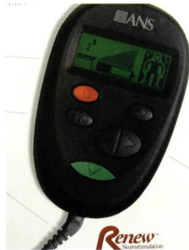
Εικόνα 7. Διεγέρτης και ρυθμιστής επισκληρίδιων ηλεκτροδίων νωτιαίου μυελού.
