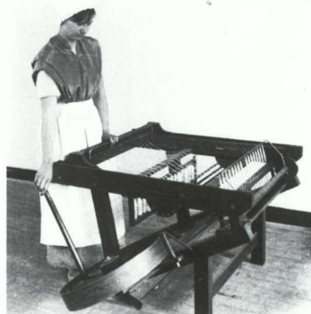
Εικ. 19 Η jenny του James Hargreaves, η πρώτη χειροκίνητη μηχανή νηματουργίας, 1764. (Ch. Aspin, The cotton industry , Shire Album 63, 9)
