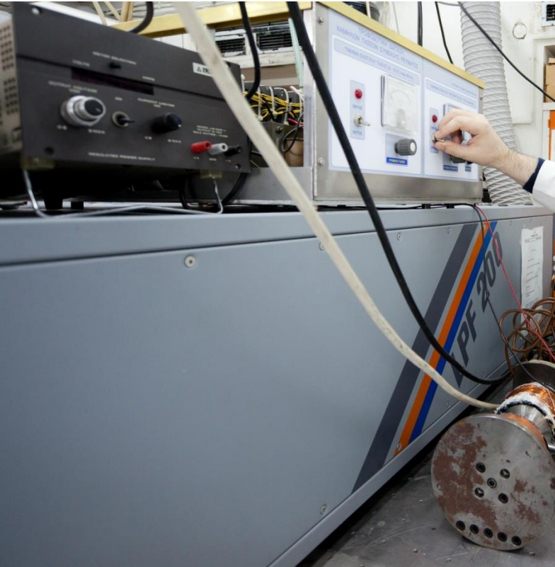
Laser Υπεριώδους Κενού (VUV) 157nm
